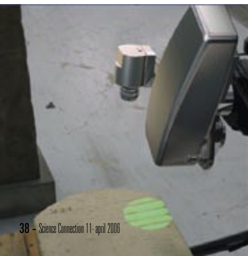
Uitrusting voor 3D-opnames door projectie van interferometrische franjes (Deios).
