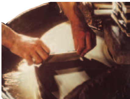
De slijpsteen wordt langs alle kanten gepolijst met een slijpmachine. Foto A. Lejeune. Privéverzameling.
