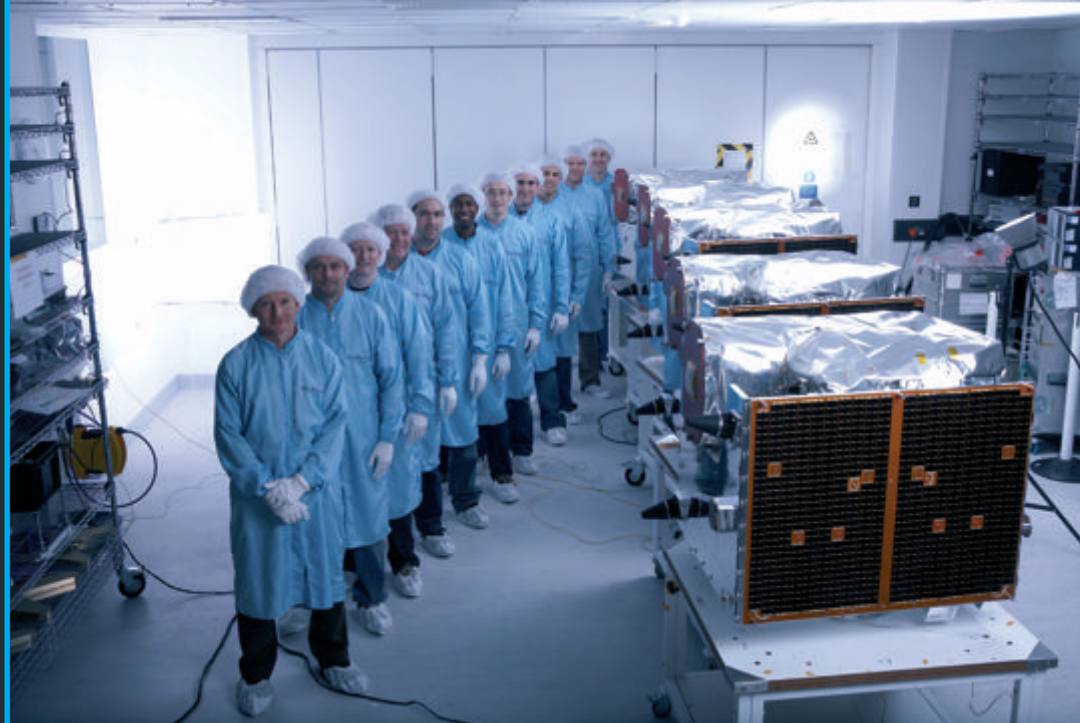
Les cinq micro-satellites RapidEye, lancés ensemble en août 2008, ils forment une constellation pour une surveillance quasi continue de l'environnement terrestre. (© SSTL)
