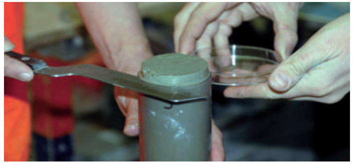
Het splitsen van sedimentstalen om verticale verdelingen van de benthische fauna te onderzoeken. © Maarten Raes & Armin Rose
