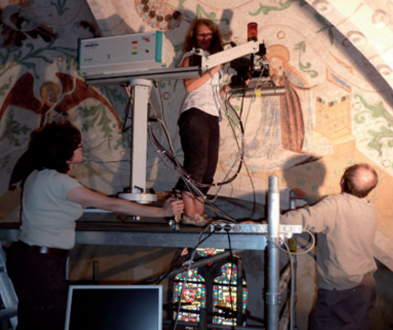
9. Onderzoek in situ : het XRF-apparaat werd gemonteerd op een stabiel voetstuk en op een stelling geplaatst. Zijn beweegbare arm maakt het mogelijk om het beschilderde oppervlak te bereiken. Elke meting duurt 2 minuten en levert onmiddellijke resultaten die worden weergegeven op een computerscherm. De wetenschappers en restaurateurs interpreteren deze resultaten en beslissen welke zones ze vervolgens zullen meten. © M. Van Bos
