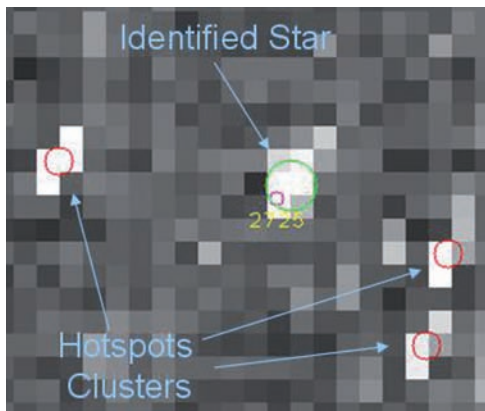
Les taches rendent l'identification des vraies étoiles difficile. © DTU
