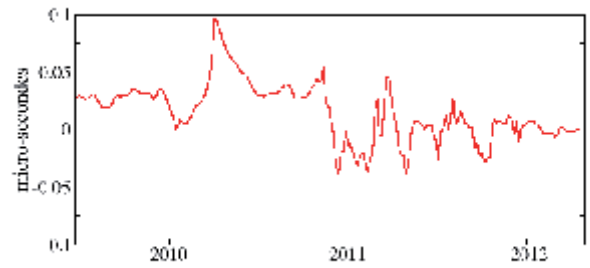
Figure 3. Comportement de UTC(ORB) par rapport à UTC durant les trois dernières années.
