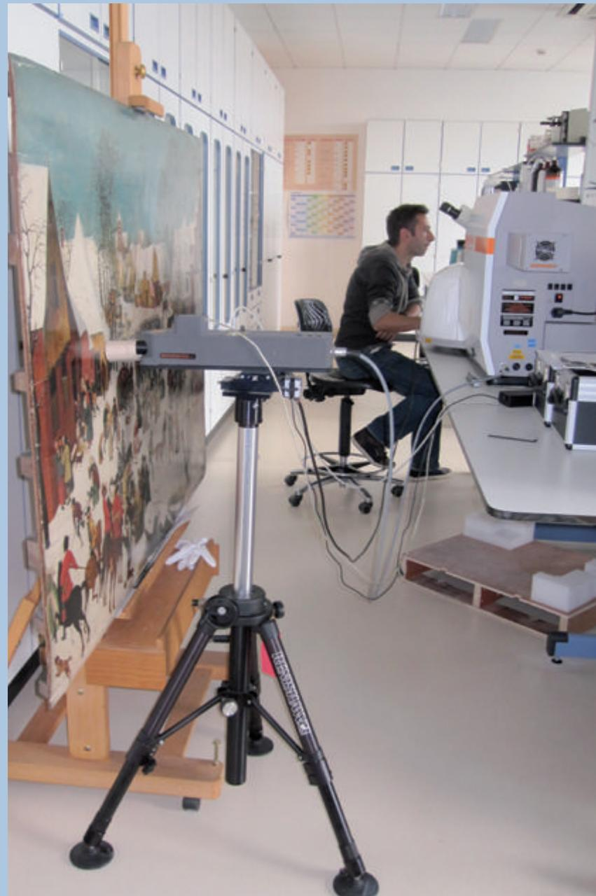
Analyse avec spectroscopie micro-Raman
