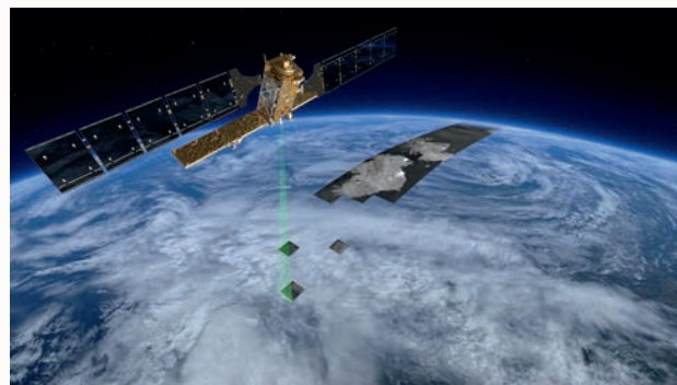
L'ESA a montré son intérêt pour ces projets: la mission Sentinel-1 est constituée de 2 satellites équipés de radar à synthèse d'ouverture.
