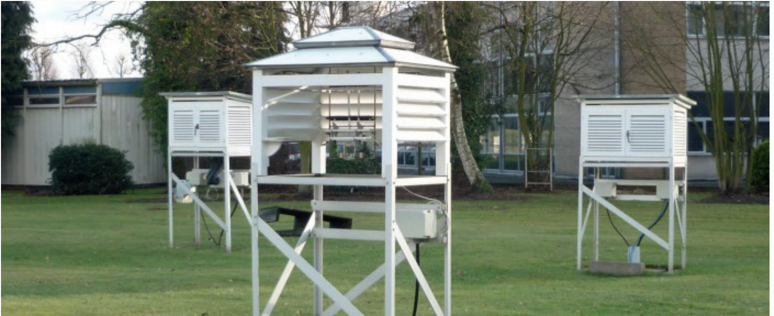
Figure 2 : Un exemple de changement de conditions de mesures : différents types d'abris thermométriques (semi-ouverts, fermés) ont été utilisés depuis la fin du 19 e siècle dans le parc climatologique à Uccle.
