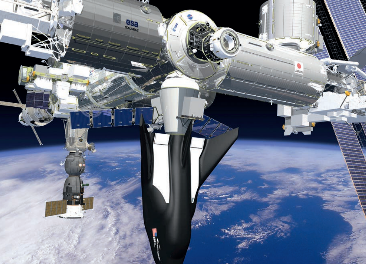
Voici comment un Dream Chaser équipé d'un module cargo sera arrimé à l'ISS. © Sierra Nevada Corporation
