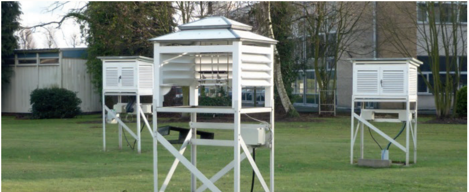
Afbeelding 2. Een voorbeeld van de veranderde meetomstandigheden: in het klimatologisch park in Ukkel worden sinds het einde van de 19de eeuw verschillende types thermometerhutten (halfopen, gesloten) gebruikt.
