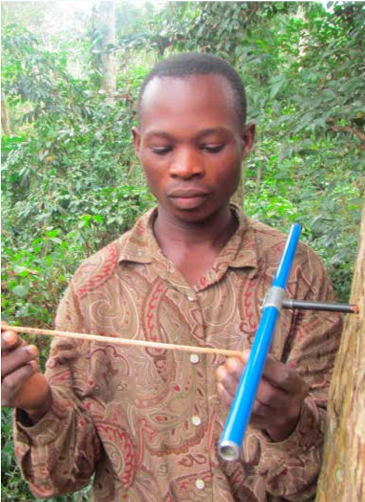
Figure 4 : Prélèvement d'une carotte à l'aide d'une mèche creuse. © Tom De Mil
