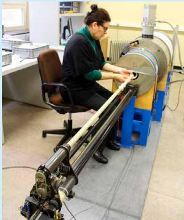
Figure 2 : magnétomètre cryogénique '2G Enterprises' pour mesurer la rémanence magnétique des terres cuites.
