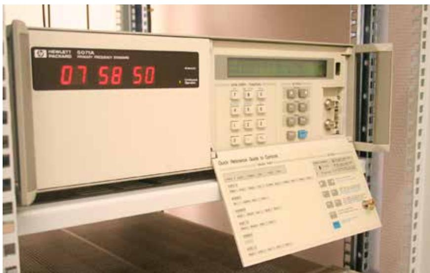
Fig. 4 : Horloge atomique à jet de césium à l'ORB. © ORB
