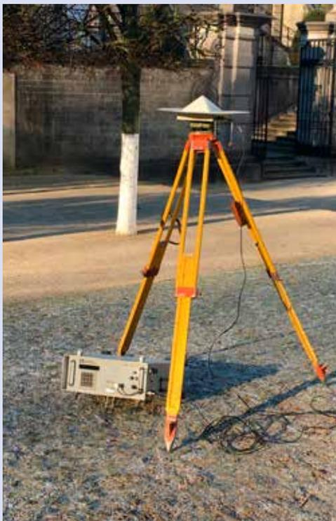
Fig. 11 : Récepteur GPS Trimble Navigation 4000SL USA, 1988, Antenne (mod. 12333) et ordinateur (mod. 12331). Institut géographique national, Inv. G 206
