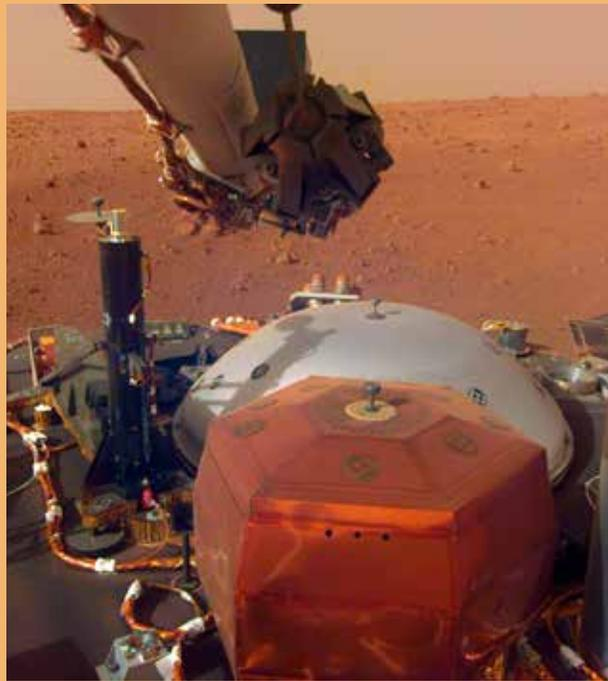
Photo des instruments SEIS et HP<sup>3</sup> sur la plateforme, avant leur déploiement, sur fond de paysage martien.
