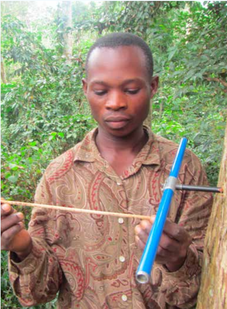
Figuur 4: Het nemen van een boorkern met een holle boor. © Tom De Mil
