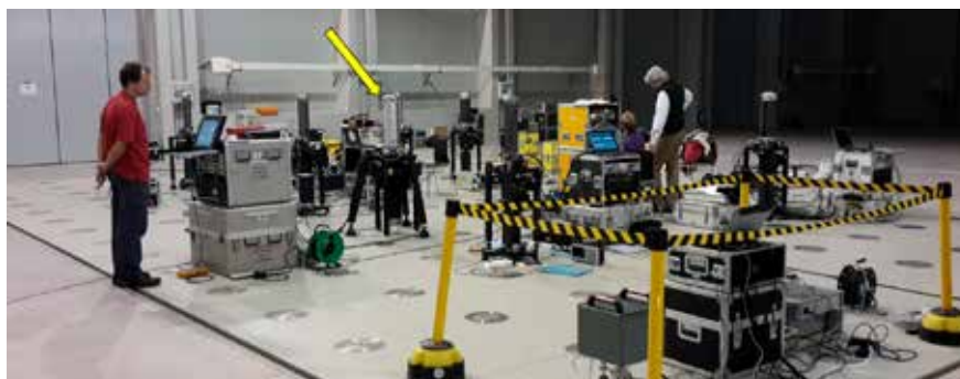
Fig. 9: Vergelijking van absolute gravimeters aan de Universiteit van Luxemburg, november 2015. De pijl duidt de absolute gravimeter FG5#202 van de KSB aan. © KSB
