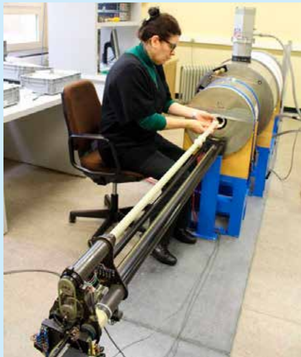
Figuur 2: de cryogene magnetometer van 2G Enterprises voor het meten van de remanente magnetisatie van gebakken klei.
