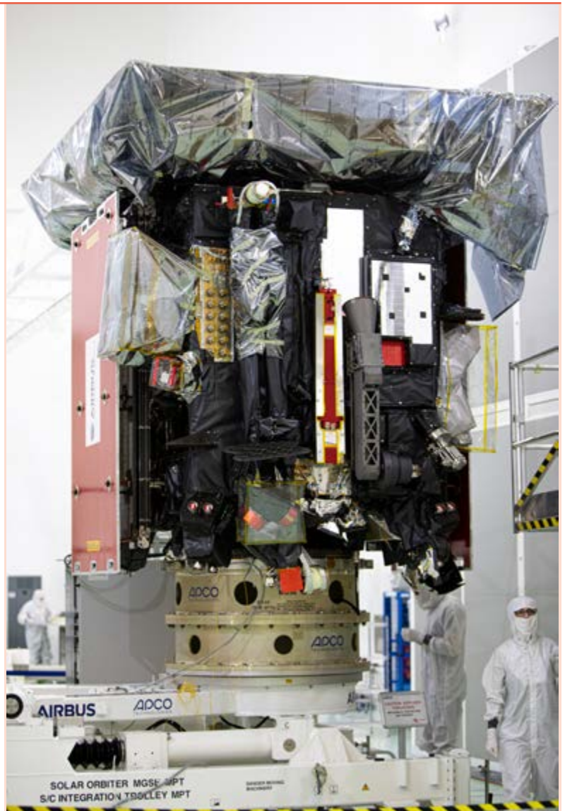
Solar Orbiter in de clean room op de lanceerbasis van het Kennedy Space Centre. Het hitteschild is nog ingepakt. Nadat alle verpakking is verwijderd zal Solar Orbiter in de lanceerraket geplaatst worden.
