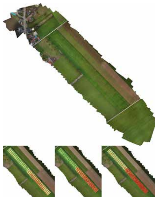
Orthophoto du site d'étude de Riemst et valeurs médianes NDVI (Normalized Difference Vegetation Index) des parcelles d'essai calculées tout au long de la saison (de gauche à droite: 8/09/2020 - 9/10/2020 - 16/10/2020)
