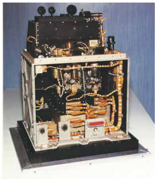
Figure 1 : L'instrument SOLSPEC de première génération, pour les missions SPACELAB, ATLAS et EURECA.
