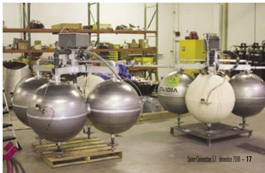
Texel et Pixel, deux spécimens d'Armadillo Aerospace de vaisseau spatial décollant et atterrissant verticalement © Armadillo Aerospace
