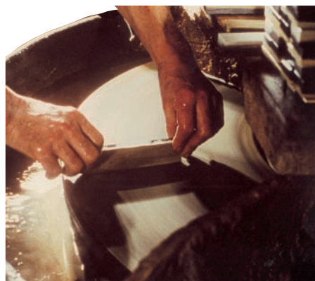
Opération de polissage au lapidaire sur toutes les faces de la pierre à aiguiser. Photo A. Lejeune. Collection privée
