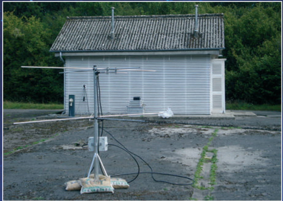
Fig. 2. De zendantenne op de site van het Geofysisch-Centrum in Dourbes. De signaalgenerator en de versterker staan in de houten barak op de achtergrond.
