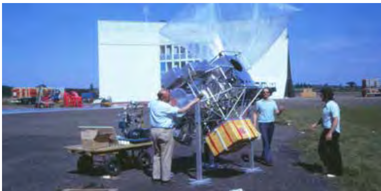
De Astrolabe-gondel, met aan boord een infraroodspectrometer, ontworpen en gebouwd op het BIRA, wordt klaargemaakt voor lancering met een stratosferische ballon.
