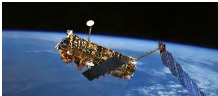
De milieusatelliet Envisat met tien instrumenten aan boord. Aan twee ervan leverde het BIRA een grote bijdrage: SCIAMACHY en GOMOS. © ESA
