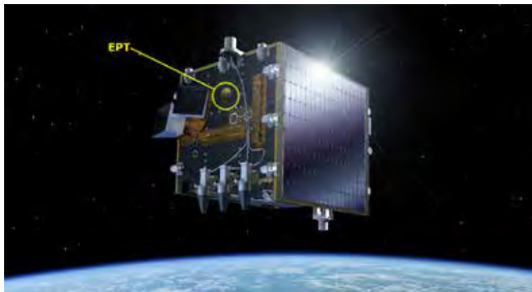
De Electron Particle Telescope (EPT), ontwikkeld door een consortium met o.a. het BIRA en geïntegreerd in de ESA-satelliet PROBA-V. © ESA
