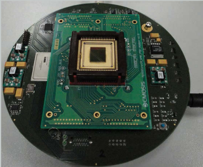
Figure 6 : Prototypage de capteur 1024x1024 pixels avec sa carte électronique de test (à gauche). A droite : capteur de modèle de vol avec 3072x3072 pixels et son emballage dédié pour le refroidissement et le raccordement électrique de la camera.
