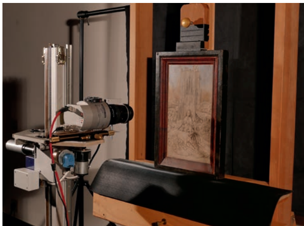
Opnames met de Lion Systems digitale infraroodcamera van Jan van Eycks Sint-Barbara in Antwerpen (Koninklijk Museum voor Schone Kunsten).
