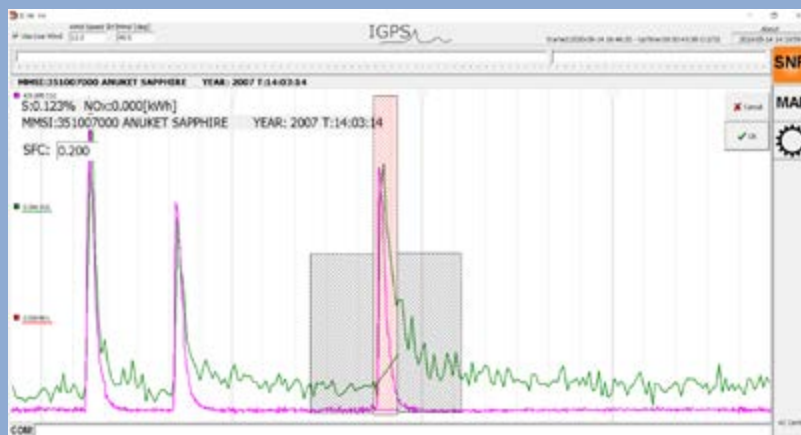
La figure de droite visualise l'effet des COV : la courbe du SO_2 sur la figure de droite (ligne verte) ne revient pas immédiatement à la concentration de fond (queue) après la mesure. Ward Van Roy de l'UGMM a développé un super-kicker-hydrocarbure qui élimine l'influence des COV sur les mesures de SO_2 . © IRSNB/UGMM
