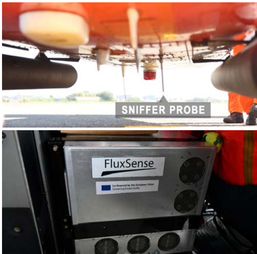
Une sonde extérieure passant à travers le ventre qui est reliée au capteur renifleur à bord de l'avion des garde-côtes. © IRSNB/UGMM
