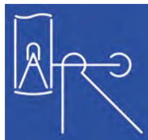
Le logo de RUSTICCA est entièrement constitué des lettres du mot RUSTICCA et représente le télescope et sa caméra : R = colonne de la monture, U = la caméra CCD, S = la lame correctrice (en réalité, elle a la forme d'un double S), T = paroi droite du tube du télescope et bras de la monture, I = paroi gauche du tube du télescope, C = le contrepois, C = le miroir, A = fenêtre d'entrée et rayons lumineux convergeant vers la caméra.
