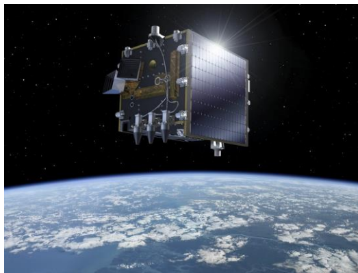
De nieuwe aardobservatiesatelliet PROBA-V is 'made in Belgium' en heeft, net als het VEGETATION-instrument aan boord, bescheiden afmetingen. Het platform heeft de afmetingen van een wasmachine en het wetenschappelijke instrument dat in eerdere gedaantes 160 kg woog, heeft een afslankingskuur ondergaan: het weegt nog amper 33 kg. Toch presteert het aanzienlijk beter. © ESA
