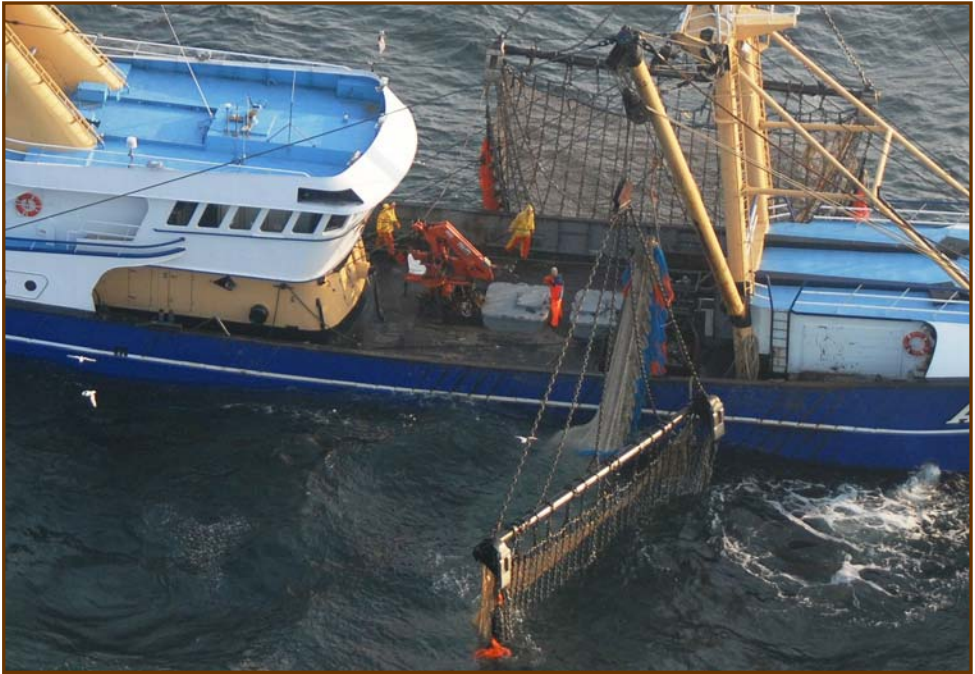
Figuur 12: In het gebied van de Westhinder wordt onder meer gevist met boomkorvaartuigen waarvan de netten omwille van de stenige bodem uitgerust zijn met wekkerkettingen (het schip op de foto heeft een motorvermogen van meer dan 2.500 kW).
