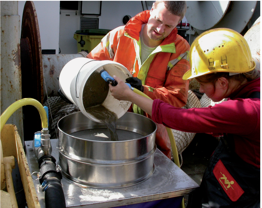
Figuur 16 Het macrobenthos wordt verzameld met behulp van een Van Veen grijper en gespoeld over een zeef met maaswijdte 1 mm.
