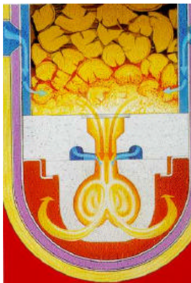
Figure 11 : Chambre à combustion d'une chaudière à tirage inversé : après la pré-gazéification des bûches, le gaz est oxydé dans une chambre à combustion indépendante par l'apport d'air secondaire [Hoval].
