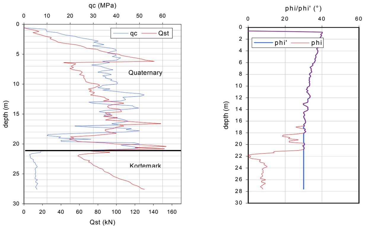
Figure 19-d: CPT ODB-S3 realised on the Oostdyck Bank (localisation UTM 31: 5680730N, 461464E) (Ministerie van de Vlaamse Gemeenschap-DLI, AOSO-Afdeling Geotechniek, 1999).  $q_c$ ,  $Q_{st}$ ,  $\phi$  and  $\phi'$  values.
