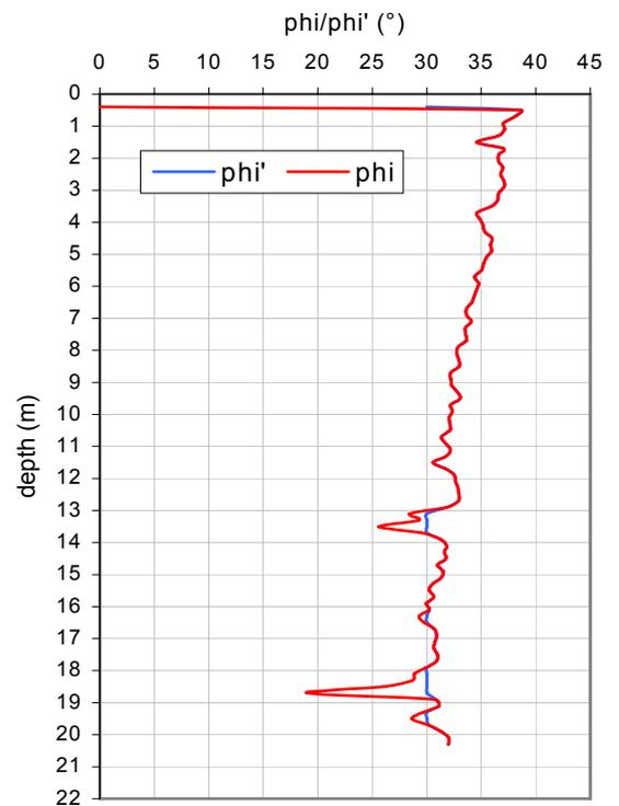
Figure 19-c: CPT ODB-S2 realised on the Oostdyck Bank (localisation UTM 31: 5680750N, 461550E) (Ministerie van de Vlaamse Gemeenschap-DLI, AOSO-Afdeling Geotechniek, 1999).  $q_c$ ,  $Q_{st}$ ,  $\varphi$  and  $\varphi'$  values.
