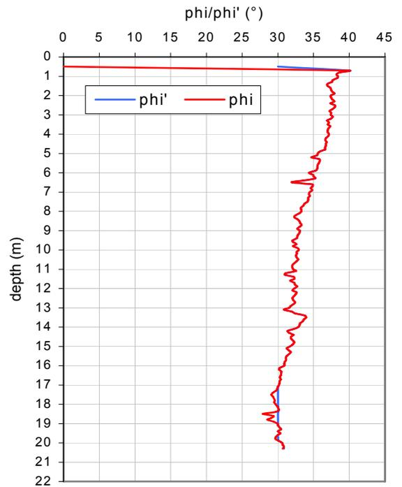
Figure 19-b: CPT ODB-S1 realised on the Oostdyck Bank (localisation UTM 31: 5680825N, 461550E) (Ministerie van de Vlaamse Gemeenschap-DLI, AOSO-Afdeling Geotechniek, 1999).  $q_c$ ,  $\varphi$  and  $\varphi'$  values.
