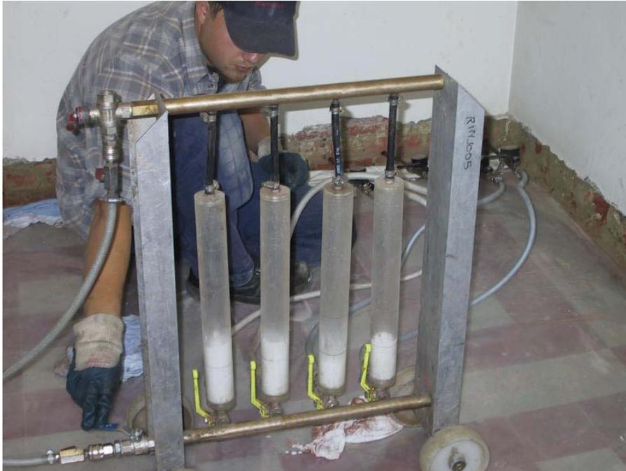
Eind november 2001 werden in het kader van dit onderzoek boorkernen van deze muur ontnomen, twee kernen ter hoogte van de injectiegaten, en twee kernen 10 à 15 cm lager. Primair doel van deze kernname was om na te gaan waar het injectieproduct in de realiteit het meest werkzaam is. Na bepaling van de algemene waterabsorptie-eigenschappen werden vervolgens de baksteen en de mortel gescheiden, en werden de absorptie-eigenschappen van beide afzonderlijk nagegaan.
