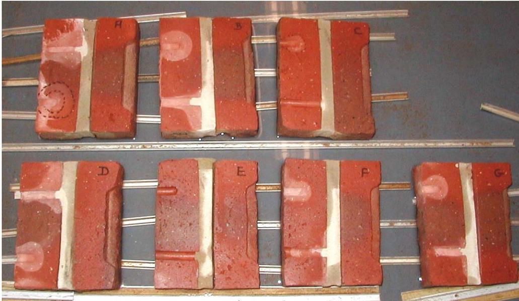
Photo 2 : vue de l'ensemble des éprouvettes après 7 jours en capillarité
