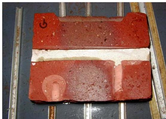
Photo 9 : éprouvettes G, visualisation de l'effet hydrophobe des traitements
