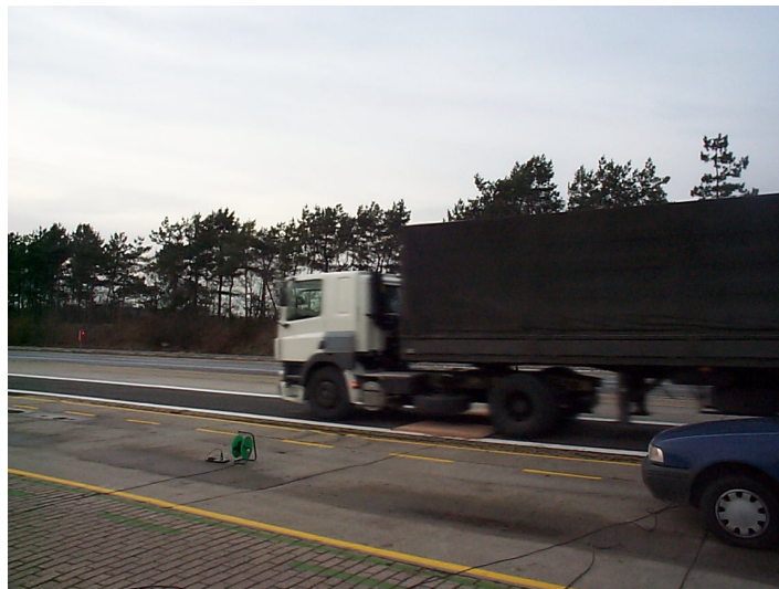
Figuur 4: De passage van een DAF FT85 vrachtwagen met oplegger over de artificiële oneffenheid op het proefcircuit van DAF te Sint-Oedenrode (Nederland).
