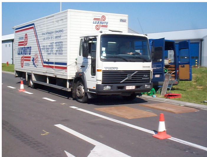
Figuur 5: De Volvo FL6 vrachtwagen en de artificiële oneffenheid op de site 'de Hemptinne' van het Belgische leger te Heverlee.
