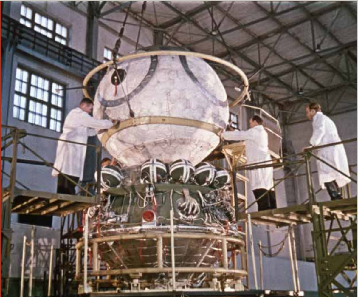
C'est dans ce vaisseau Vostok de forme sphérique que le jeune pilote Youri Gagarine est devenu le cosmonaute n°1 de l'Histoire. © RKK Energia
