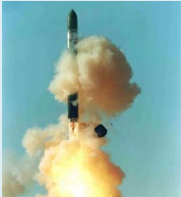
Le lanceur russo-ukrainien Dnepr, dérivé du missile intercontinental Satan, est tiré depuis un silo. Il a déjà permis le lancement de plusieurs micro- et nano-satellites. © ISC Kosmotras
