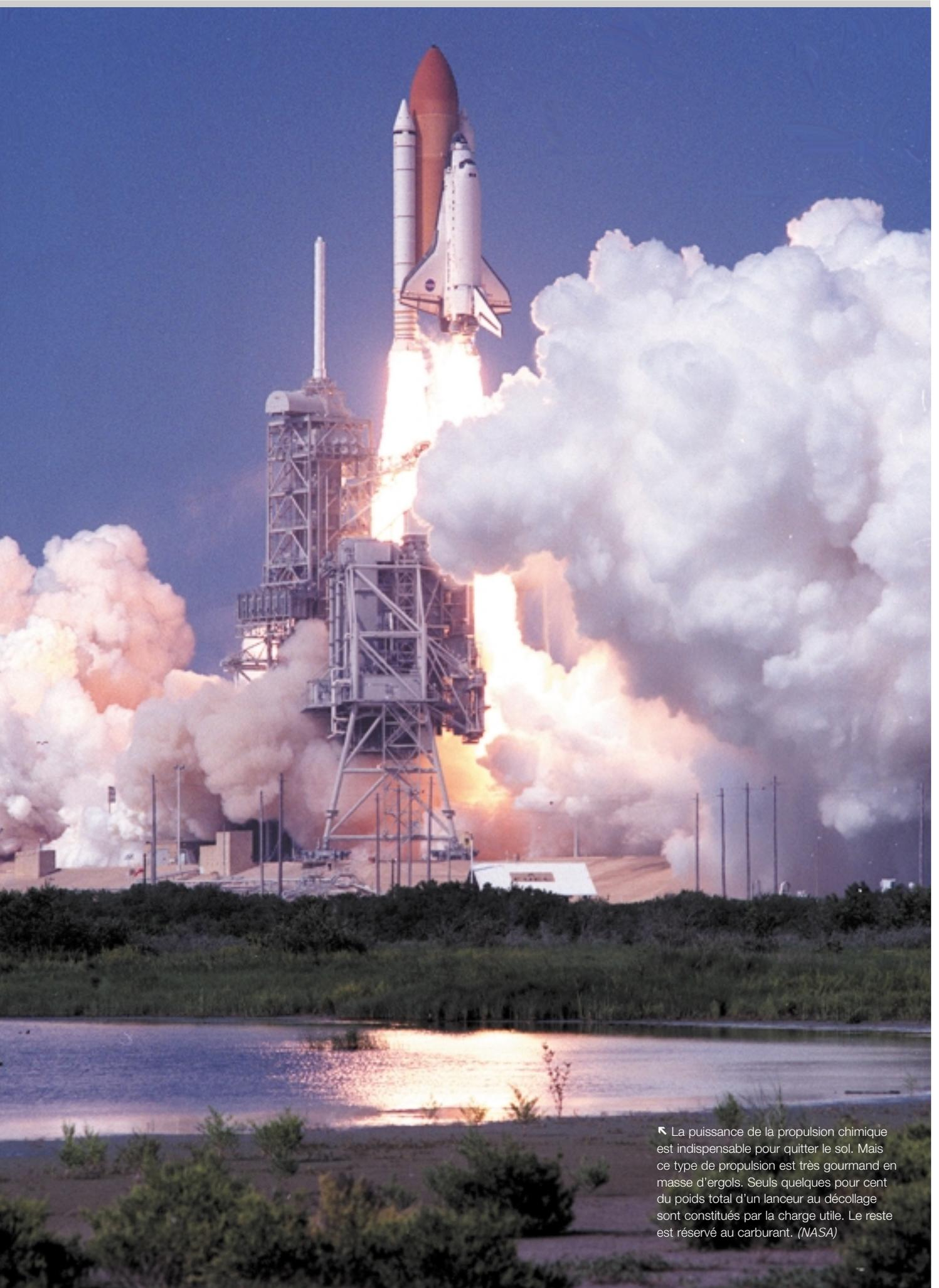
☞ La puissance de la propulsion chimique est indispensable pour quitter le sol. Mais ce type de propulsion est très gourmand en masse d'ergols. Seuls quelques pour cent du poids total d'un lanceur au décollage sont constitués par la charge utile. Le reste est réservé au carburant. (NASA)
