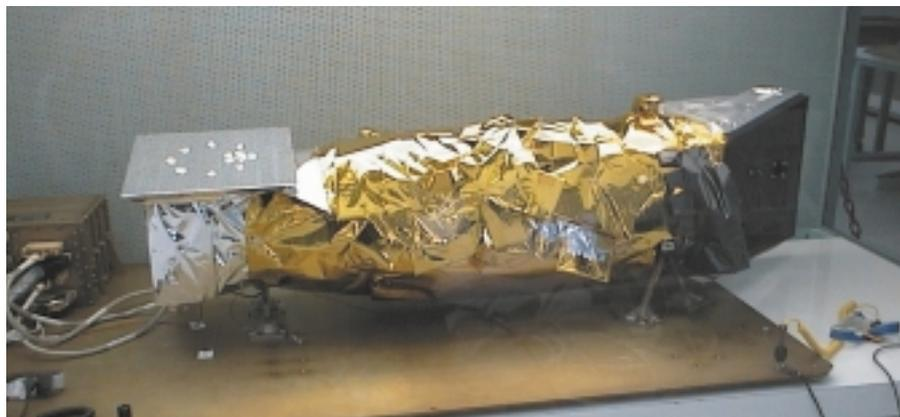
existant sur Soho et a été monté à bord d'une fusée sonde de la NASA. Cette mission, baptisée CALROC, permet d'assurer la recalibration du premier EIT grâce à des observations conjointes de la couronne solaire.
