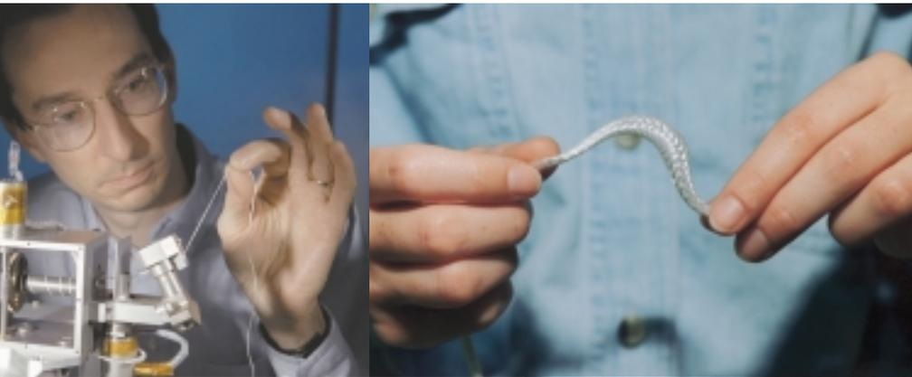
← Le long câble qui doit servir à désorbiter plus rapidement le dernier étage d'un lanceur est extrêmement mince. (NASA)
