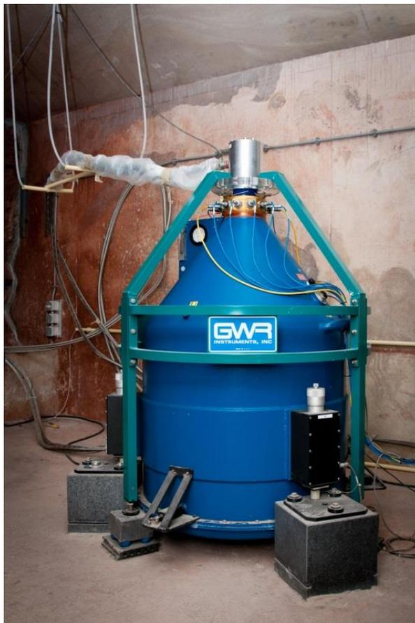
Le gravimètre à supraconductivité, installé à l'extrémité d'une galerie longue de 140 m de long, excavée sous la Forêt ducale (« Hertogenwald »), entre les barrages d'Eupen et de la Gileppe.
