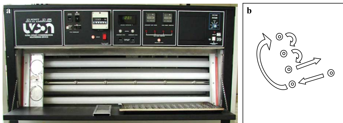
Figuur 7: Atlas ® UVCON a) binnenzicht b) rotatieschema van de lampen
