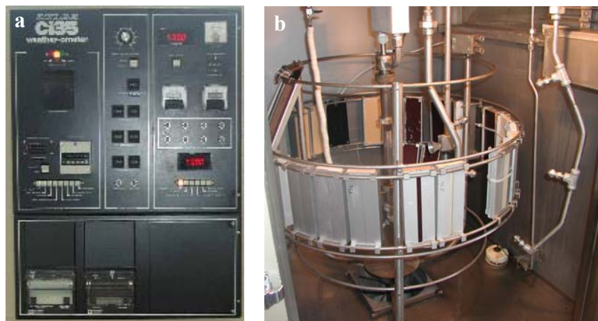
Figuur 8: Atlas ® Ci weather-Ometer a) besturingspaneel b) binnenzicht
