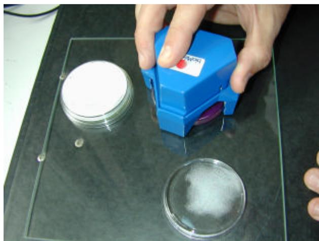
Les boîtes RODAC sont appliquées sur les plaques en verre à l'aide d'un applicateur automatique
