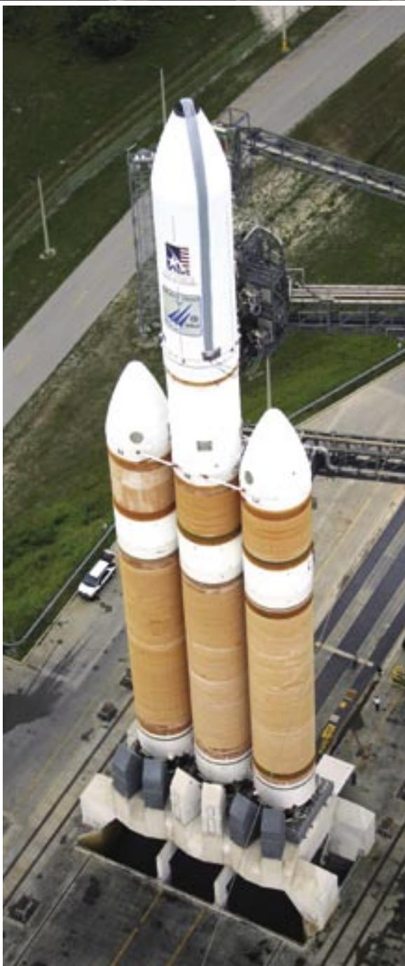
*Pour la génération des lanceurs Delta IV, Boeing Launch Systems a conçu et développé un module propulsif à propulsion cryogénique.*
