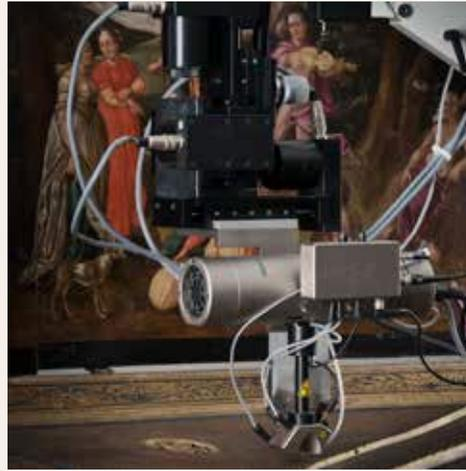
Appareil Artax micro-XRF destiné à l'analyse des pigments des décors de table et caisse des instruments Ruckers. Analyses effectuées par Steven Saverwyns et Marina Van Bos de l'IRPA © mim
