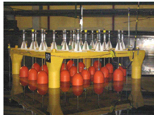
Figuur 26: multi-puntabsorptiesysteem op basis van de FO 3 (SEEWEC, 2009)
