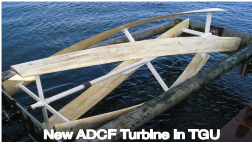
Figuur 53: Cross flow turbine klaar om in het water te plaatsen (Ocean Renewable Power, 2009)
