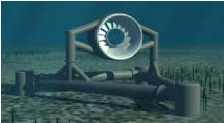
Figuur 51: Bodemgemonteerde open centrum turbine (IEA-OES et al, 2009c)
