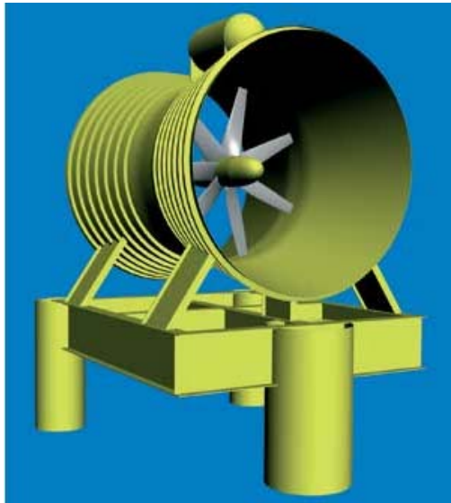
Figuur 50: Bodemgemonteerde bidirectionele horizontale as turbine gehuisd in een symmetrische in- en uitlaatconstructie (Lunar Energy, 2009).
