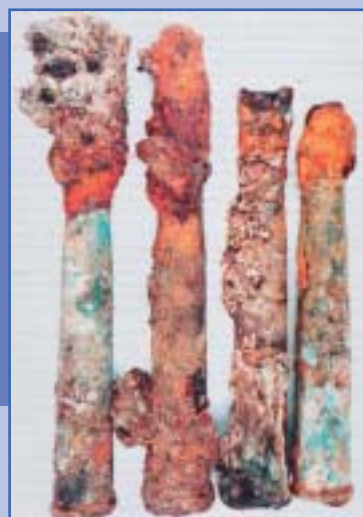
Duitse WOII granaten (van vergelijkbaar kaliber) bovengehaald in de Waddenzee. De munitie zit vaak onder een dikke korstlaag en vertoont opvallend weinig corrosie. In hoeverre dit ook geldt voor de Paardenmarkt valt echter niet met zekerheid te zeggen.
