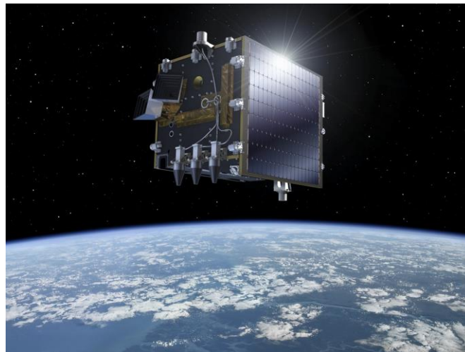
Le nouveau satellite d'observation de la Terre PROBA-V est "made in Belgium". Tout comme son instrument VEGETATION, il est de dimensions modestes. La plateforme a la taille d'une machine à laver tandis que l'instrument scientifique, qui affichait dans ses versions précédentes une masse de 160 kilos, est désormais miniaturisé. Il ne fait plus que 33 kilos et voit dans le même temps ses performances nettement améliorées. © ESA
