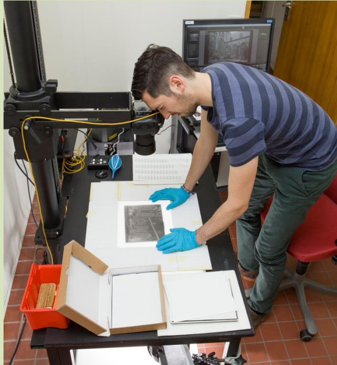
Fig. 1 : Digitalisation d'un cliché allemand par photographie à haute définition sur table lumineuse. © KIK-IRPA, Bruxelles, cliché Katrien Van Acker, 8 mars 2016, X092619.
