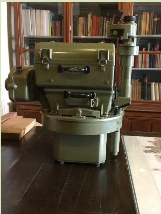
Chambre photographique WILD RC8, en service à l'IGN entre 1962 et 1985, Institut géographique national
