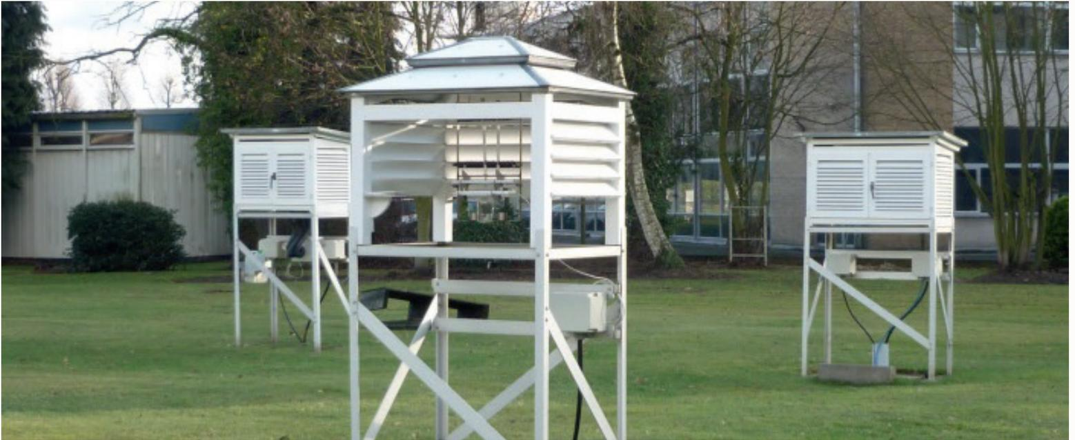
Figure 2 : Un exemple de changement de conditions de mesures : différents types d'abris thermométriques (semi-ouverts, fermés) ont été utilisés depuis la fin du 19<sup>e</sup> siècle dans le parc climatologique à Uccle.
