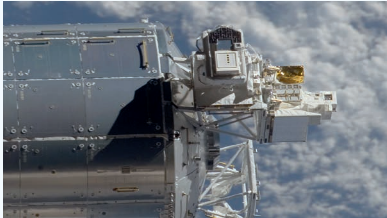
Afb. 2: het SOLAR-pakket op de Europese COLUMBUS-module van het internationaal ruimtestation. SOLAR is sinds maart 2008 operationeel (document ESA).
