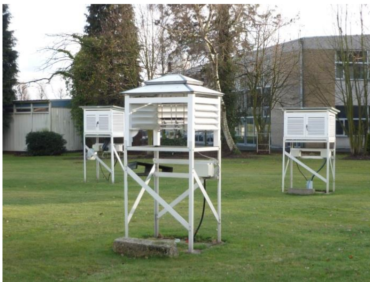
Fig 1: Un exemple de changement de conditions de mesures: différents types d'abris thermométriques (semi-ouverts, fermés) ont été utilisés depuis la fin du 19ème siècle dans le parc climatologique à Uccle.
