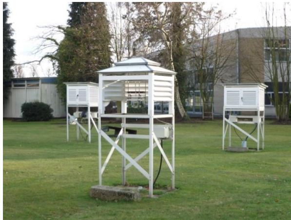
Fig 1: Een voorbeeld van de veranderde meetomstandigheden: in het klimatologisch park in Ukkel worden sinds het einde van de 19de eeuw verschillende types thermometerhutten (halfopen, gesloten) gebruikt.
