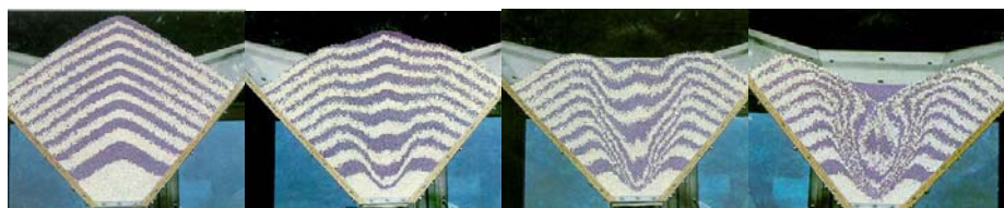
Figure 5. - Illustration visuelle de la vidange d'une trémie (Doc. BASF).
