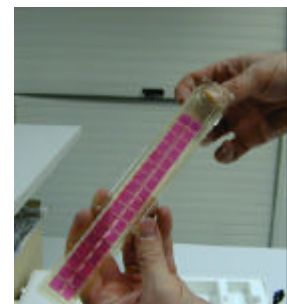
6b. ...le côté gélosé tourné vers la partie la plus convexe de l'étui
