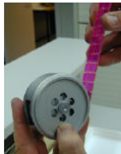
5b. , la languette est ensuite extraite de la tête amovible du RCS+
