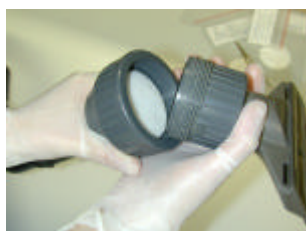
5. Mise en place du filtre dans l'embout
