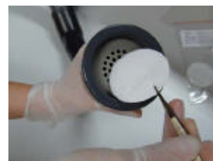
4. Mise en place du filtre dans l'embout
