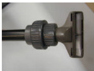
1. Embout spécial porte filtre utilisé par l'ISP-Mycologie
