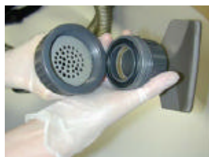
2. Ouverture de l'embout avant l'échantillonnage
