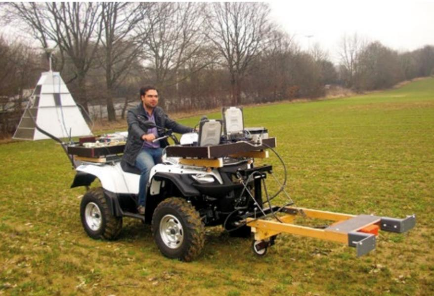
L'instrument radar à pénétration de sol (ou radar géologique) est monté sur un quad pour effectuer des mesures en temps réel de l'humidité du sol.
