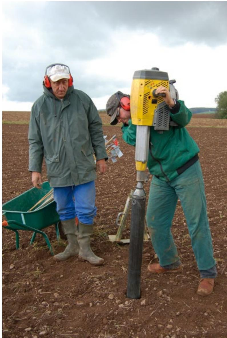
L'extraction d'une carotte intacte de sol d'environ 1 m de long se fait à l'aide d'un carottier à percussion. La distribution verticale du carbone est ensuite analysée.
