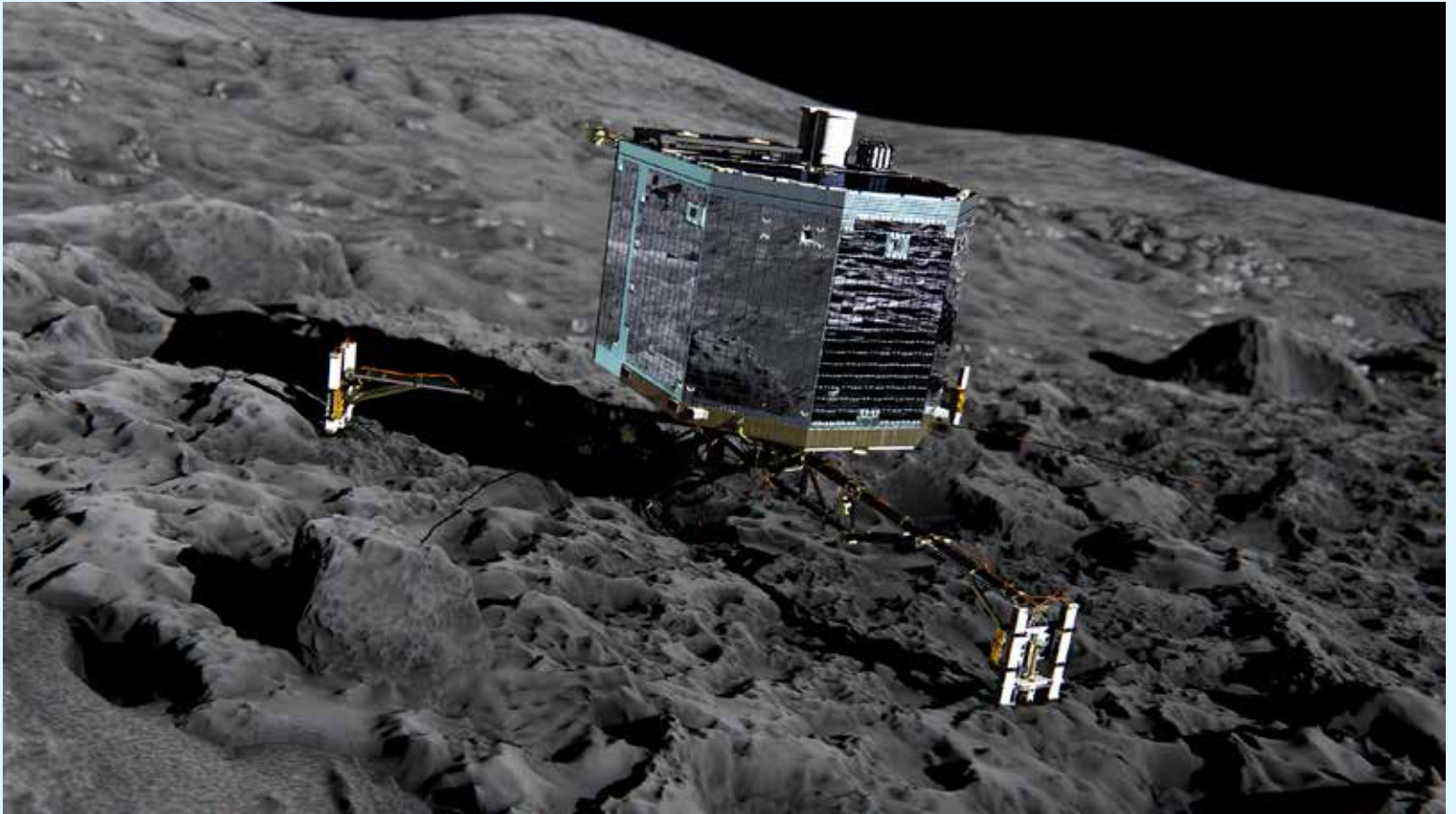
De lander Philae moet de eigenschappen van de komeetmaterie onderzoeken. Daartoe beschikt de lander over een boorsysteem en analyse-apparatuur. © ESA
