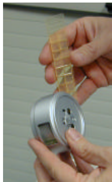
5b. , la languette est ensuite extraite de la tête amovible du RCS+
