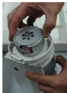
5a. Dès que le prélèvement d'air a été effectué, la tête amovible est dégagée
