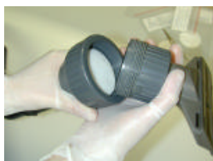
5. Mise en place du filtre dans l'embout
