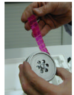
4a. La languette est introduite dans la tête amovible
