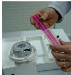
3. Une languette de milieu gélosé est soigneusement retirée de son étui stérile
