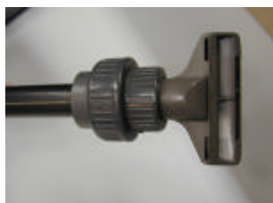
1. Embout spécial porte filtre utilisé par l'ISP-Mycologie
