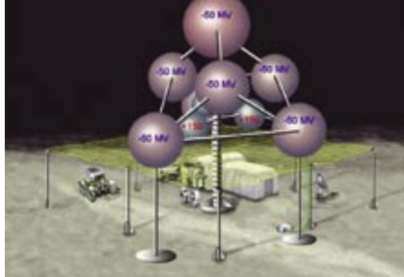
Concept van een 'elektrostatisch beschermerschield' boven een maanbasis, dat astronauten moet beschermen tegen gevaarlijke kosmische stralingsdeeltjes. De mogelijkheid van een dergelijk schild is onderzocht door het NASA Institute for Advanced Studies. © NASA
